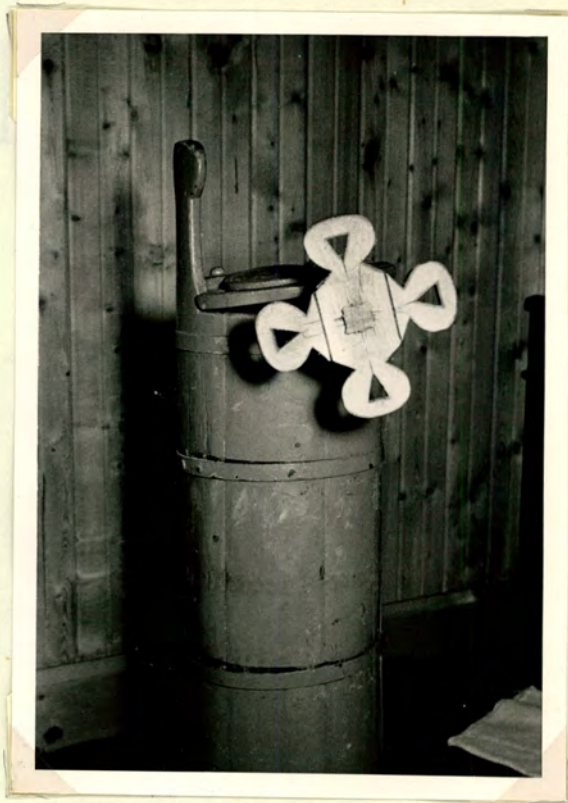
Fig. 4. smörtsjå , 'smörkärnan' med töreln , 'töreln' eller 'kärnstaven'.
